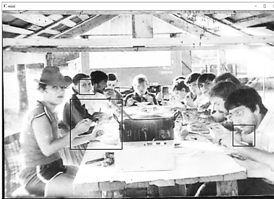
Рис. 1. Пример результата работы функции detectmultiscale из библиотеке OpenCV
